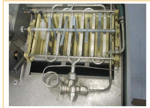
Fig. 15: Evaporador de un fabricante de cubitos.
