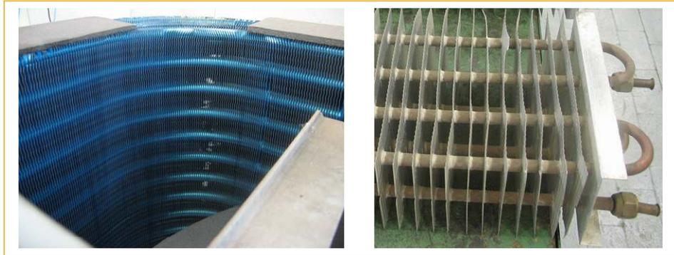
Fig. 28: Comparación de aletas entre un condensador (izq.) y un evaporador (dcha.).
