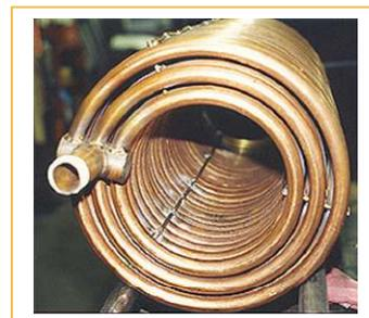
Fig. 33: Serpentín de un condensador de agua de inmersión.
