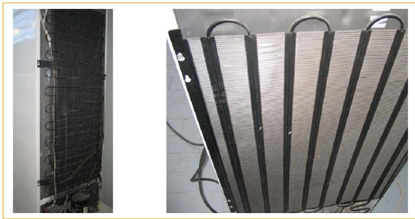
Fig. 30: Condensadores en refrigeradores domésticos.
