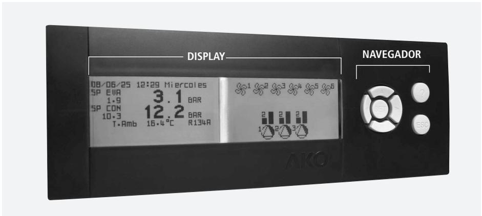
El DISPLAY está compuesto de 2 pantallas, el color de fondo de cada una puede ser configurada por parámetros de usuario.
